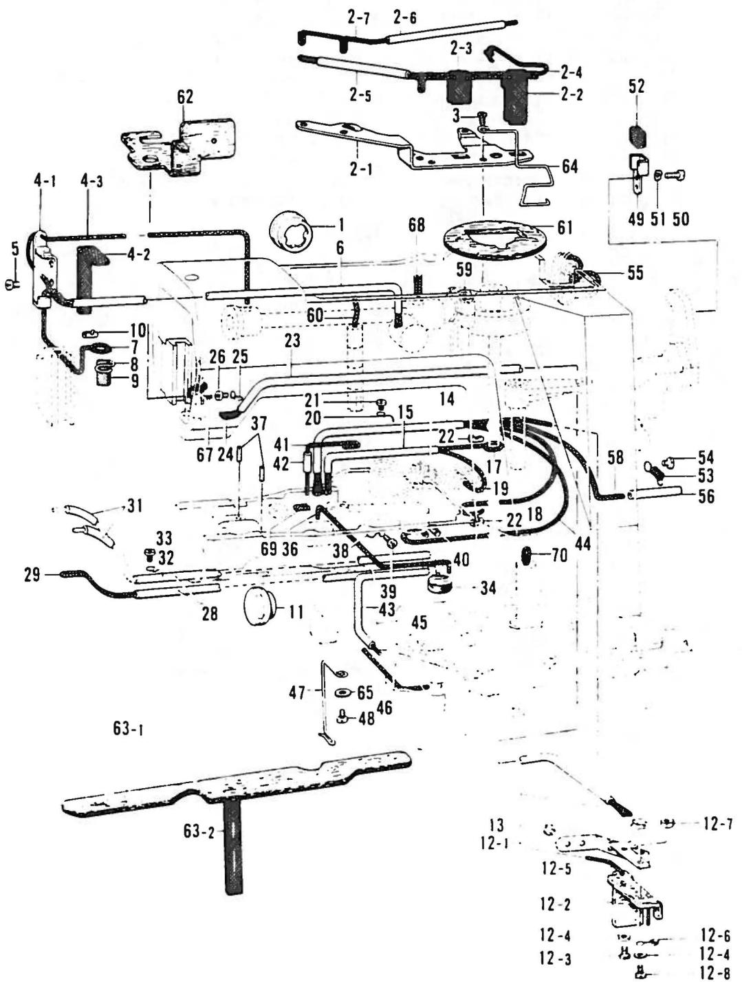
K. 給油潤滑関係 / Lubrication/Schmierung/Lubrification/Lubricación
