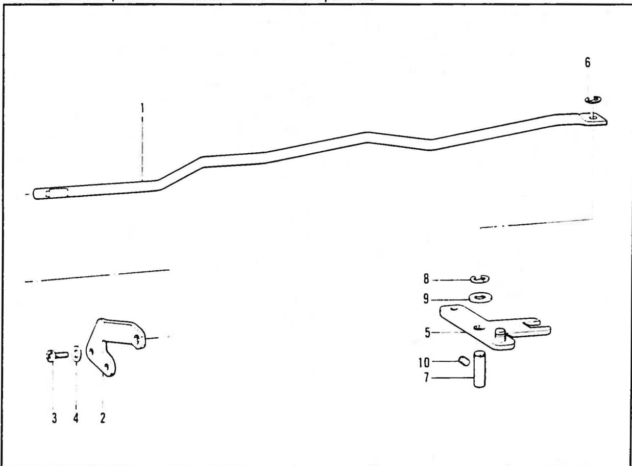
P. 糸払い関係 / Thread wiper mechanism / Fadenwischvorrichtung /
