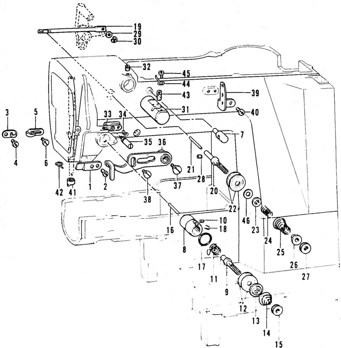
L. 糸通シ関係 / Threading mechanism / Fadenführungs vorrichtung /
