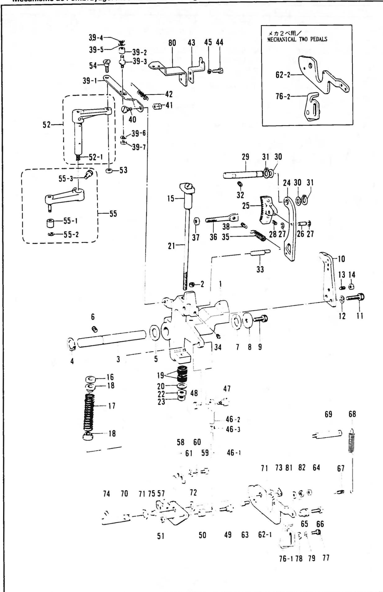
B. クラッチ関係/Clutch mechanism/Kupplungsvorrichtung/
