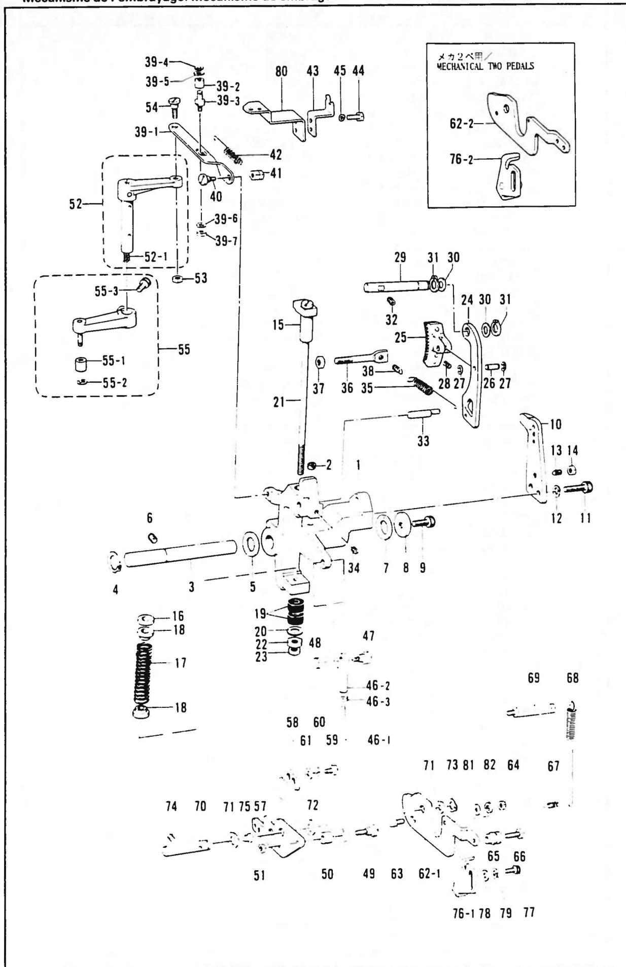
B. クラッチ関係 / Clutch mechanism / Kupplungsvorrichtung /
