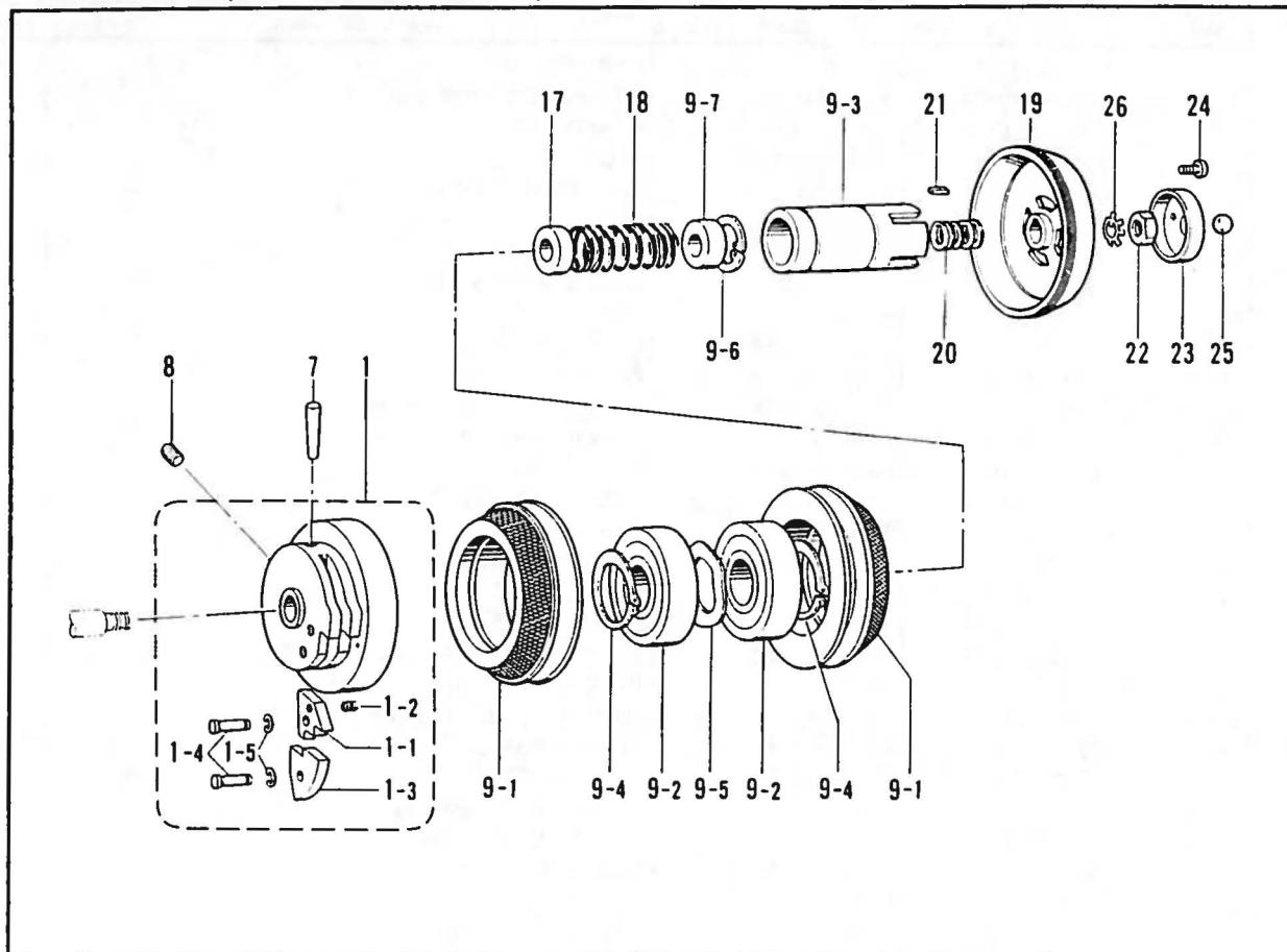
D. 動車遊車関係 / Drive pulley and idler pulley mechanism / Antriebsriemenscheibe und Riemenscheibe /
