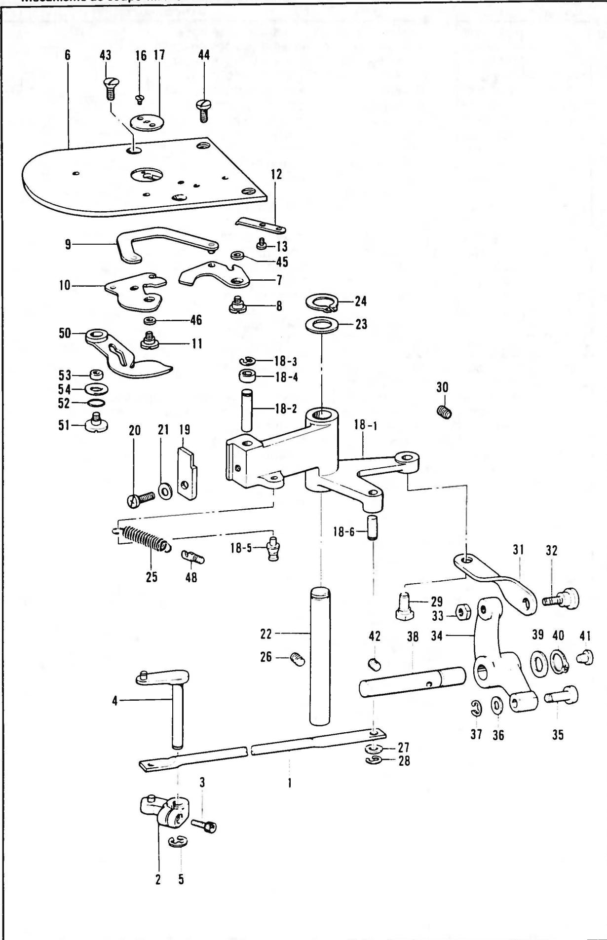
N. 糸切り関係 / Thread trimmer mechanism / Fadenabschneidevorrichtung /
