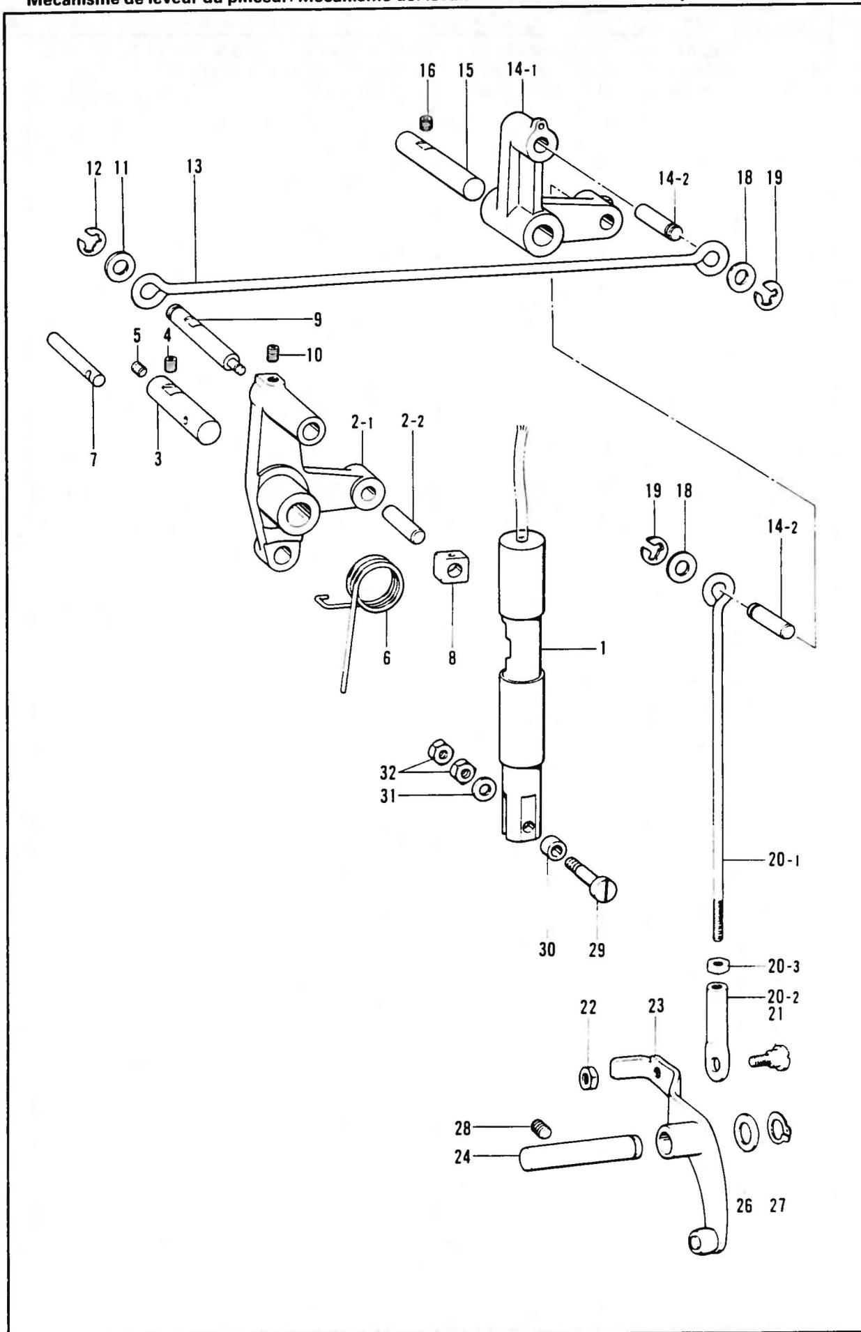
F. 押工上げ関係 /Work clamp lifter mechanism/Stoffhalterhebervorrichtung/
